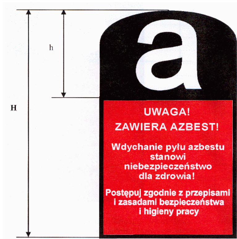
Rysunek 6. Wzór oznakowania dróg utwardzonych odpadami zawierającymi azbest (H = min. 30 cm).
