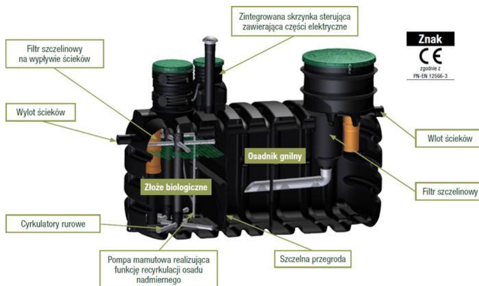
Rysunek 17. Schemat oczyszczalni hybrydowej
