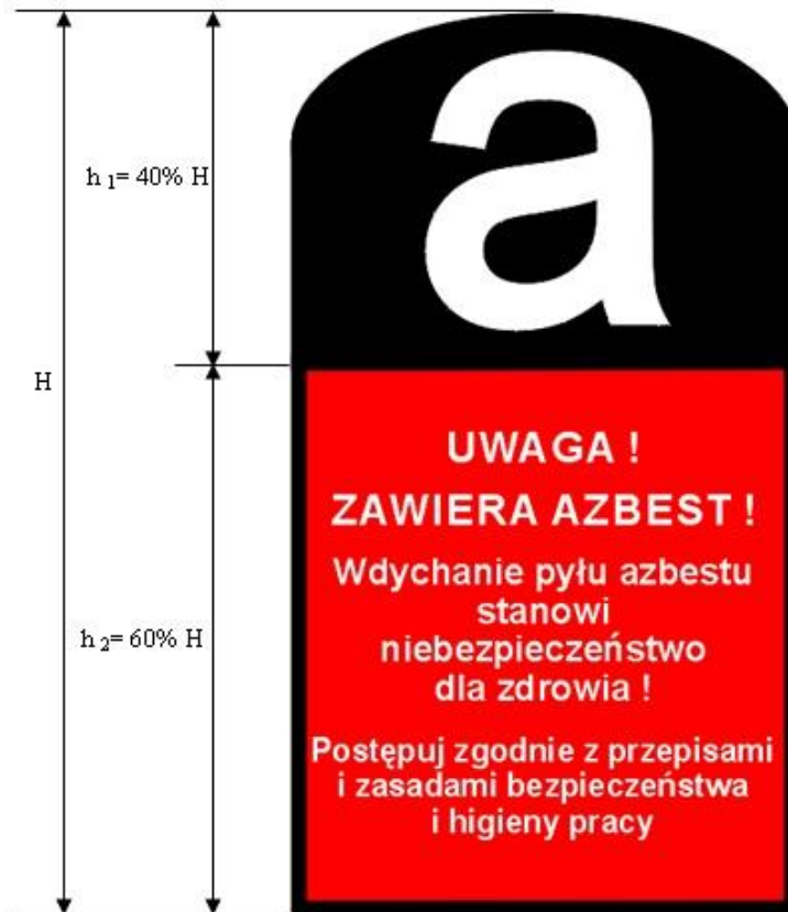
Rysunek 5. Wzór oznakowania instalacji lub urządzeń zawierających azbest oraz rur azbestowo-cementowych.
